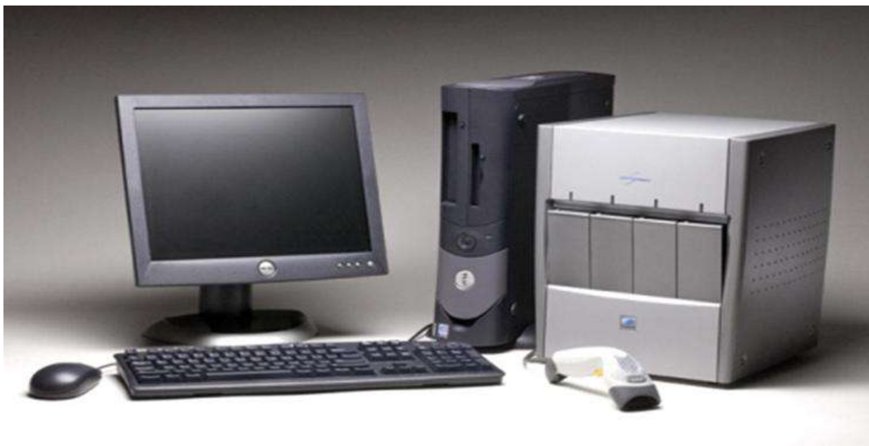
Рисунок 1 Xpert-MTB/Rif (Персональный компьютер, Сканнер для штрих-кода, Программное обеспечение, Одноразовые картриджи с реагентами, буфером и промывочным раствором)
